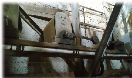
En haut : ancien système d'inversion mécanique. A droite : chaîne d'entraînement et nouveau moteur installés sur la cloche principale.
